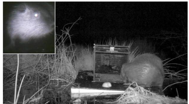
Abbildung 16: Eine Nutria betritt die selektive Lebendfalle. Das eingeschobene Foto zeigt die Aufnahme der Kamera in der Falle. Das Bild wird unmittelbar von einem Algorithmus analysiert und klassifiziert.
