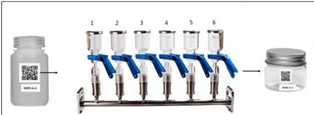
Abbildung 10: Schema der Verarbeitung der Wasserproben. Das Wasser aus der Plastikflasche wird gefiltert und anschließend wird das Filterpapier, das die eDNA enthält, weiterverarbeitet.
