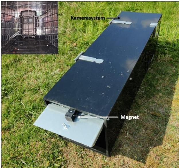
Abbildung 14: Aufbau des Prototyps einer selektiven Lebendfalle mit Magnet an der Fallenklappe und einem Bilderkennungssystem mit Kamera im Hinterraum der Falle. Das eingeschobene Foto zeigt das Bilderkennungssystem in der Falle.
