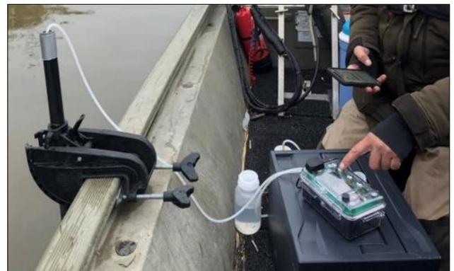
Abbildung 9: der DNA-Auto-Sampler im Einsatz vom Boot aus. Die Wasserproben werden über einen Schlauch gezogen und in einer Plastikflasche gesammelt.
